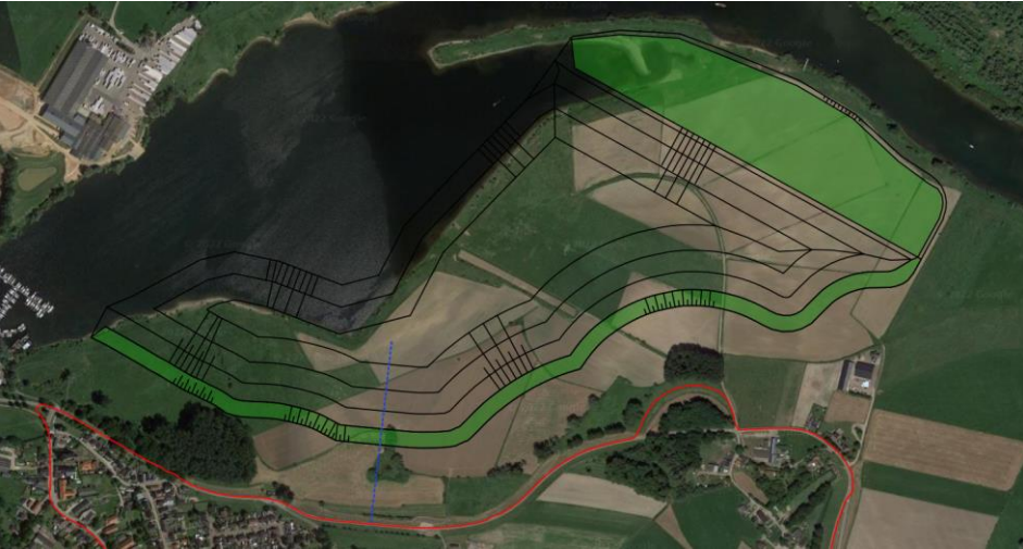
Figuur 2-1 Locatie zandwinput nabij Alem. Ontgraving zandwinput aangegeven met zwarte lijnen, oeverzone in groen en de dijk rond Alem met rood. De locatie van dwarsdoorsnede 3 (DP3), zie Figuur 2-2, is aangegeven met de blauwe stippellijn
