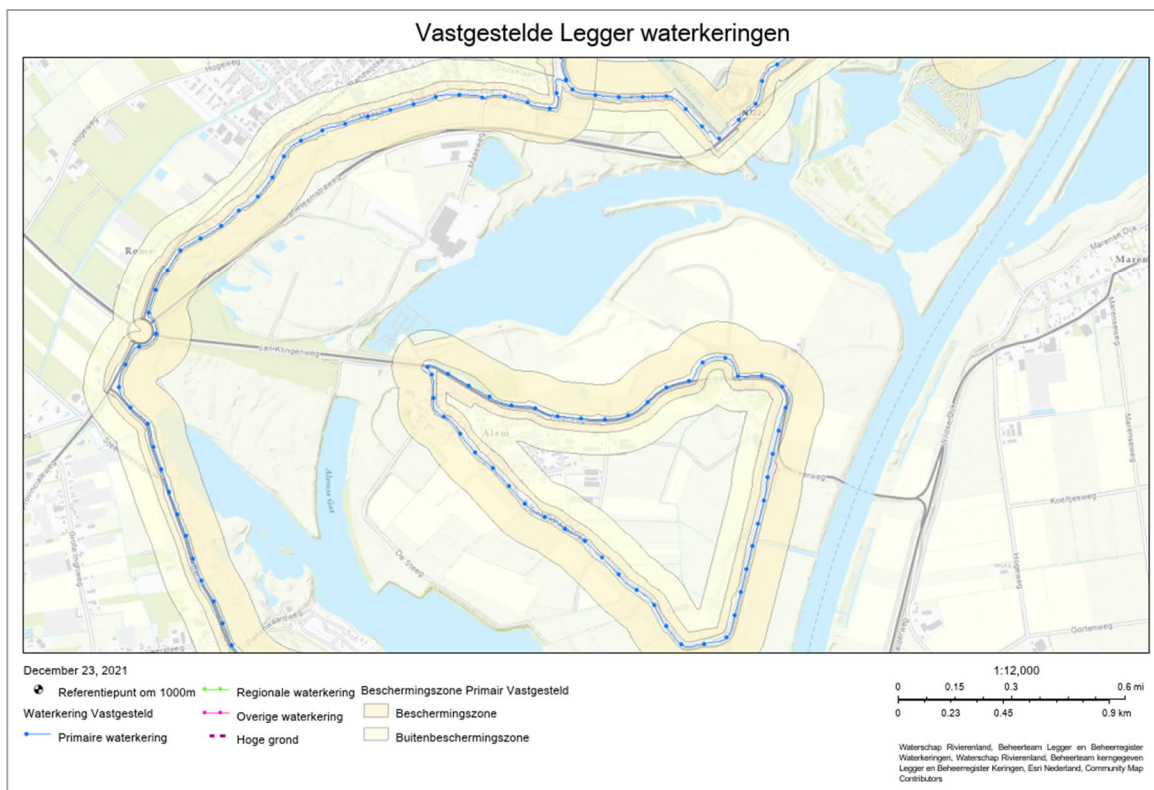
Figuur 2-12 Legger waterkeringen Waterschap Rivierenland
