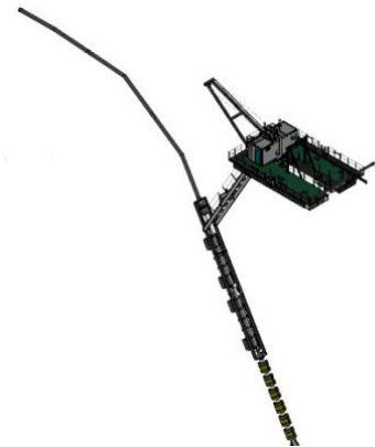
Schets van autonome zandzuiger zoals deze de komende tijd gebouwd gaat worden op de Bomhofspas. Bron: Dekker Groep
