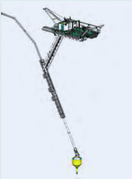
De eerste versie die niet stabiel genoeg bleek, was met losse drijvers en ladder uitgevoerd.
