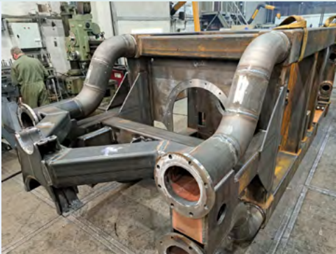
In de werkplaats wordt nog hard gewerkt aan de bouw van pompunit.
